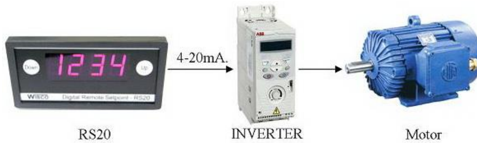
ปรับ Speed ของ Inverter
