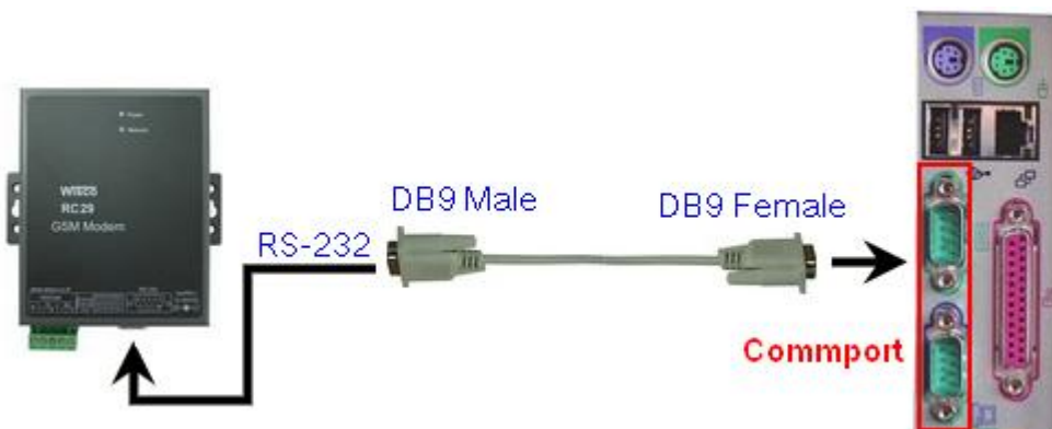
การเชื่อมต่อ RC29 กับเครื่องคอมพิวเตอร์ผ่านทาง Serial Port
