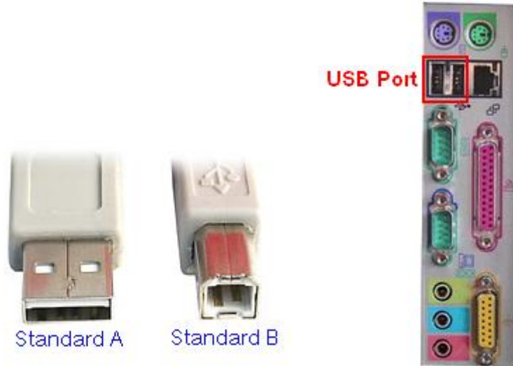
สาย USB และ USB Port ของเครื่องคอมพิวเตอร์
