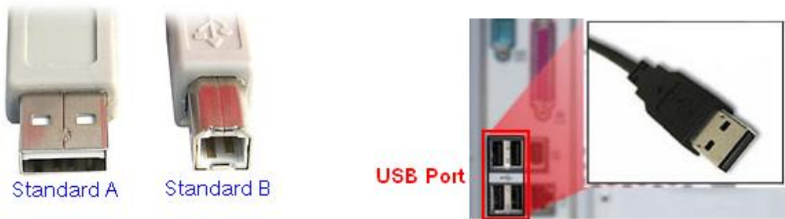
สาย USB และ USB Port ของเครื่องคอมพิวเตอร์
