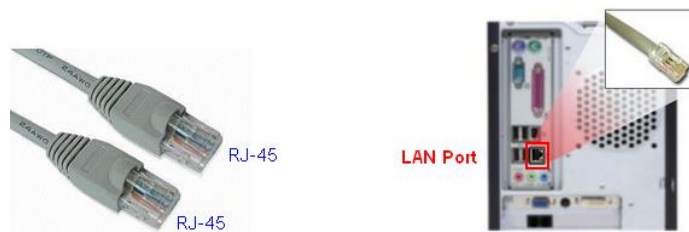
สาย LAN และ LAN Port ของเครื่องคอมพิวเตอร์
