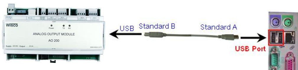
การเชื่อมต่อ AO200 กับเครื่องคอมพิวเตอร์ผ่านทาง USB Port
